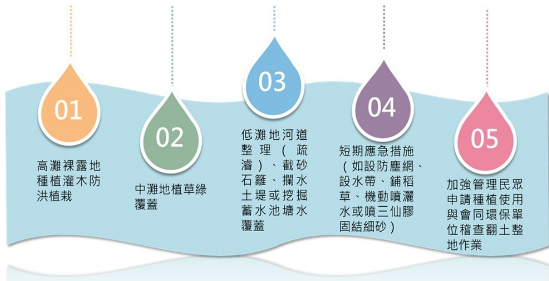
圖 10、河川揚塵防制措施，以減少懸浮微粒濃度
