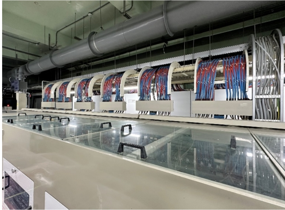
圖 22、印刷電路板製程密閉式蒐集
