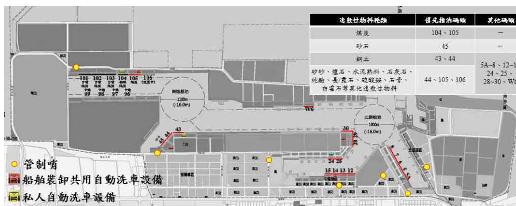
圖 2.4.1-2、臺中港逸散物料裝卸碼頭位置圖
