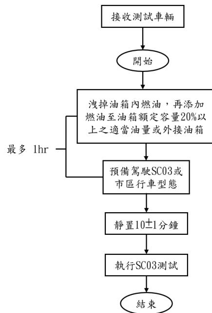
圖四 SC03 型態之污染排放測試步驟
