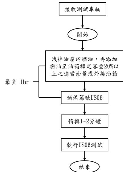
圖三 US06 型態之污染排放測試步驟
