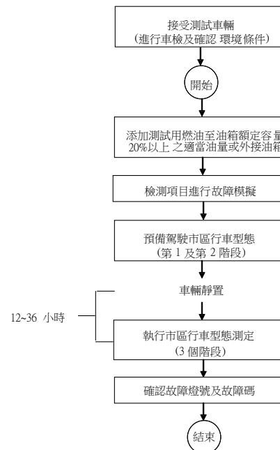
圖三 OBD 排放污染測試步驟
