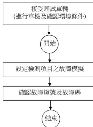
圖五 OBD 斷線測試步驟
