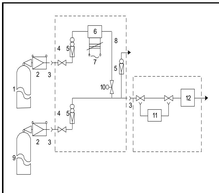
圖 十一 NO<sub>2</sub>-NO 轉換器確認管路圖
