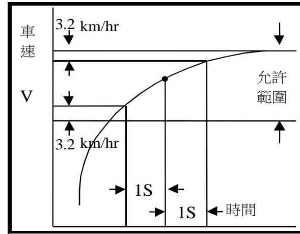
圖 七 加速或減速階段偏差量容許圖
