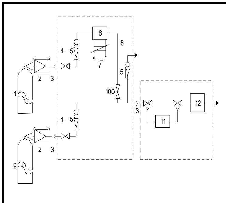
圖 九 NO<sub>2</sub>-NO 轉換器確認管路圖
