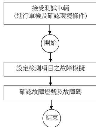
圖 七 車上診斷系統(OBD)斷線測試步驟
