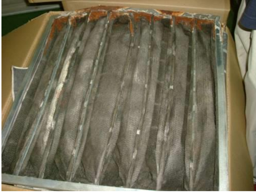
圖 19 空調系統過濾網損壞情形
