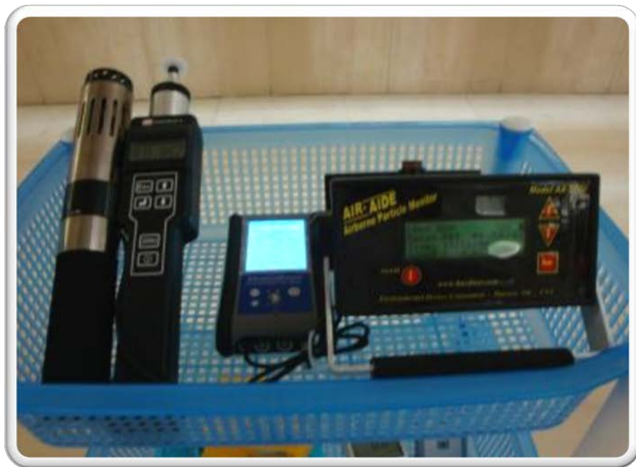
圖2 巡檢式檢測儀器測定室內空氣污染物之情形(置於工作車或平台)
