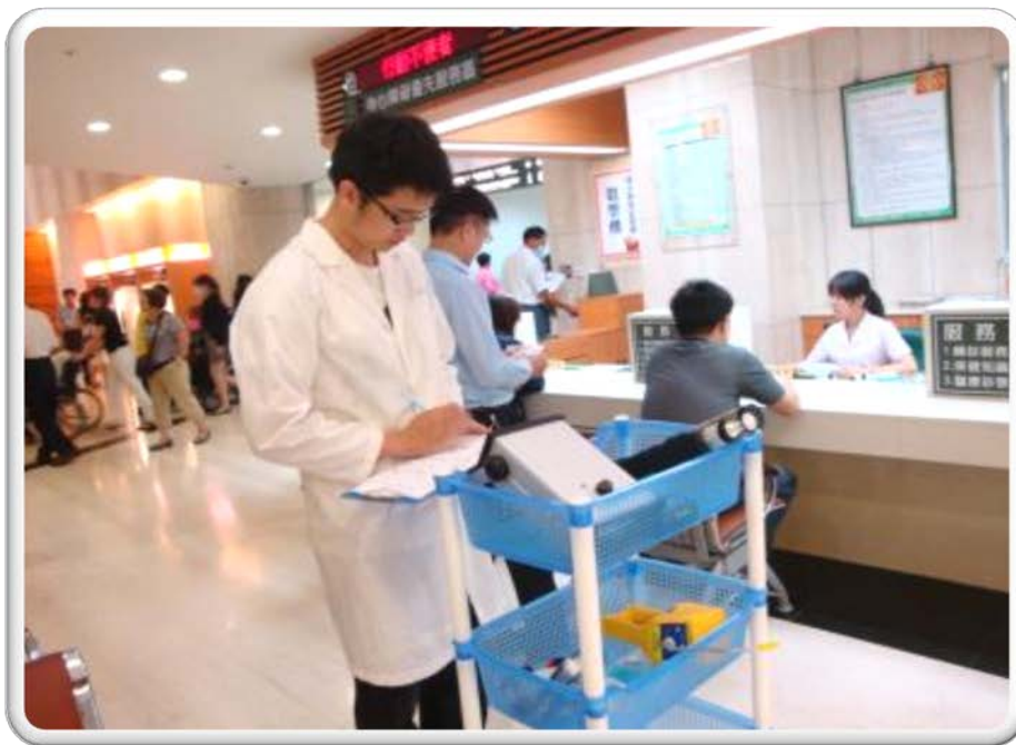
圖2 巡檢式檢測儀器測定室內空氣污染物之情形(置於工作車或平台)
