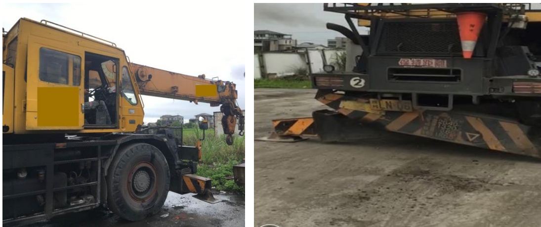
圖4-13 起重機外觀及排煙狀況
