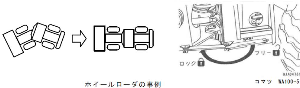
圖3 輪式裝載機曲桿應將其固定為筆直狀態
