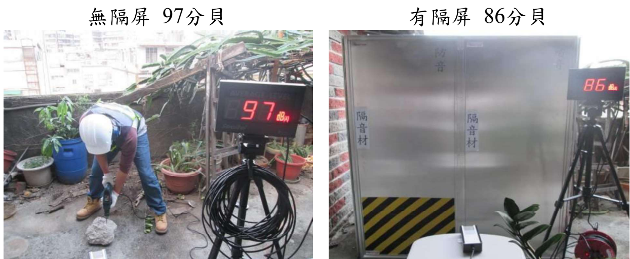
圖 21 防音隔屏實測示意圖
