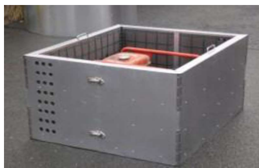
圖 11 機具部分設備加裝隔音罩
