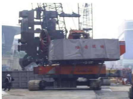
圖 11 機具部分設備加裝隔音罩
