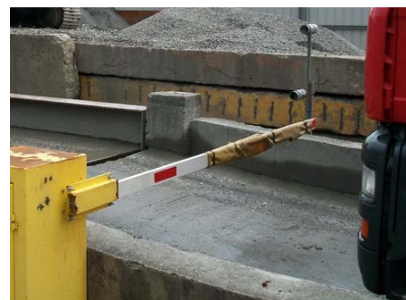
於自動洗車設備出口裝設閘門
