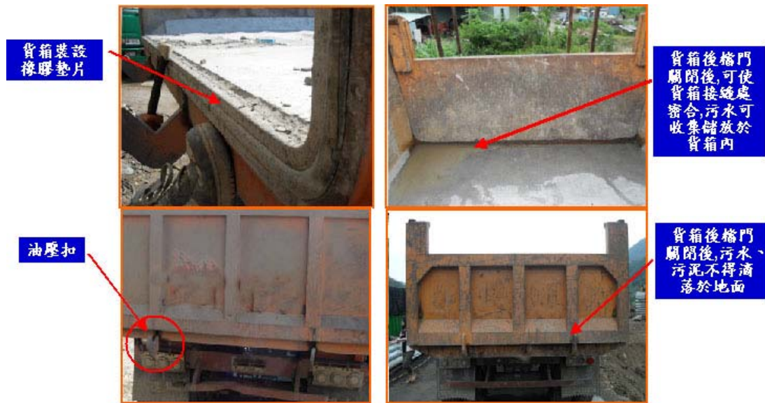
圖3-19 砂石車貨箱設置阻隔設施實照
