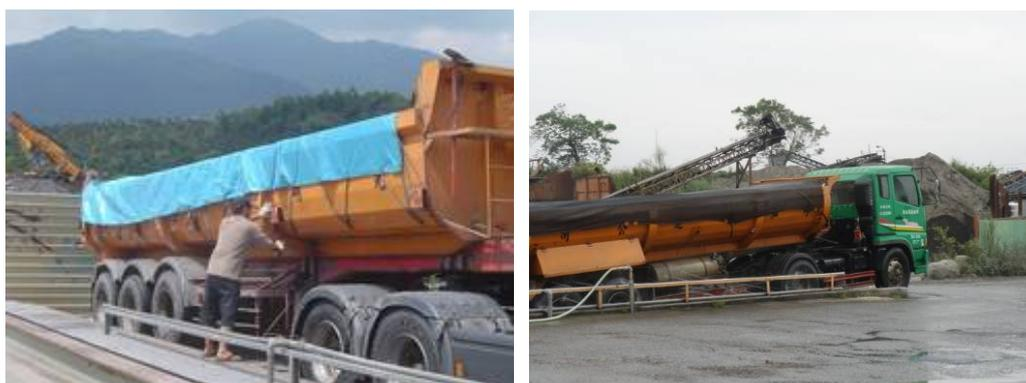
圖3-17 砂石車貨箱覆蓋防塵布(網)實照
