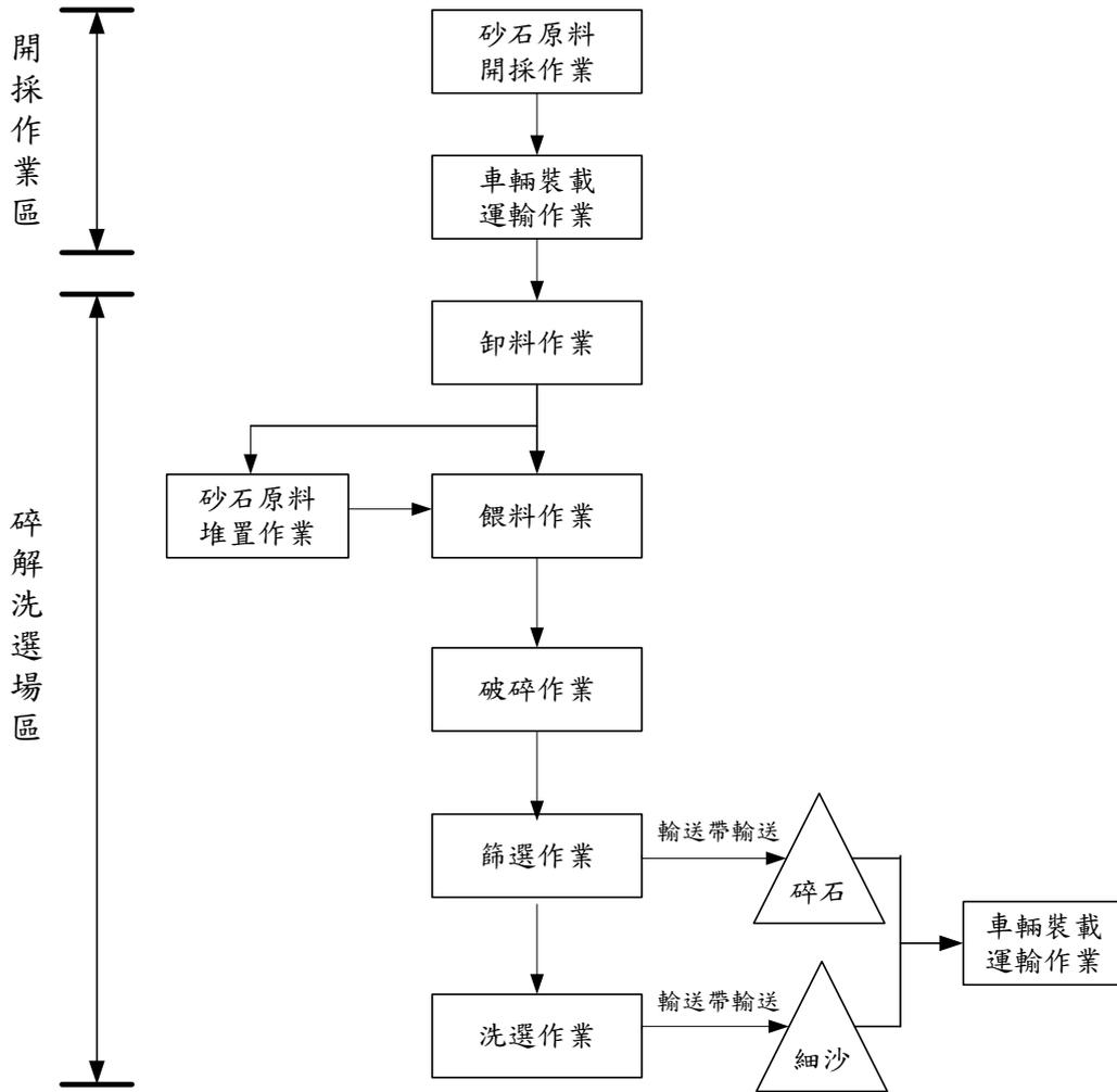
圖2-1 砂石採集處理作業流程圖
