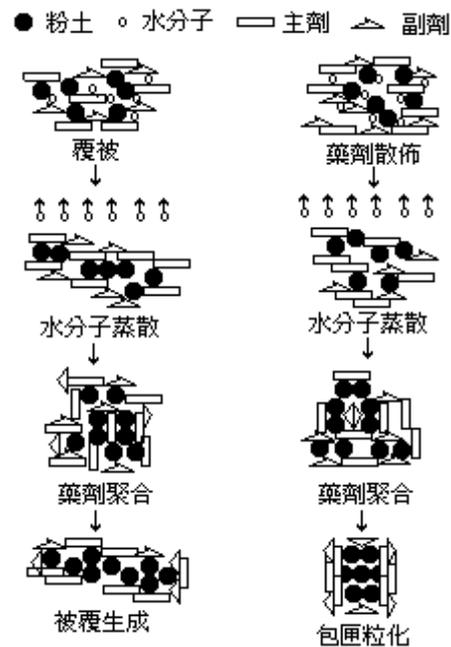
圖3-14 化學穩定劑防塵機制示意圖
