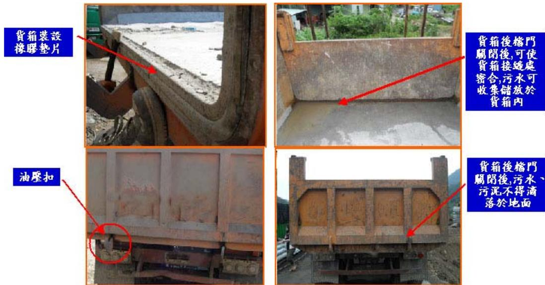
圖3-19 砂石車貨箱設置阻隔設施實照
