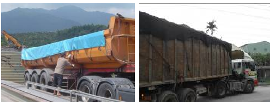
圖3-17 砂石車貨箱覆蓋防塵布(網)實照
