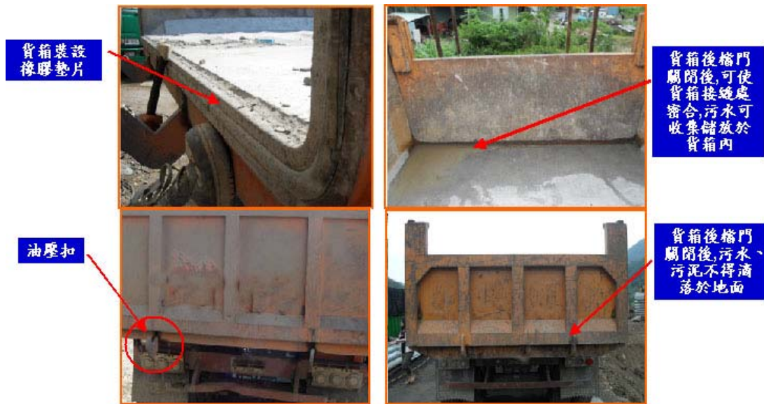
圖3-19 砂石車貨箱設置阻隔設施實照
