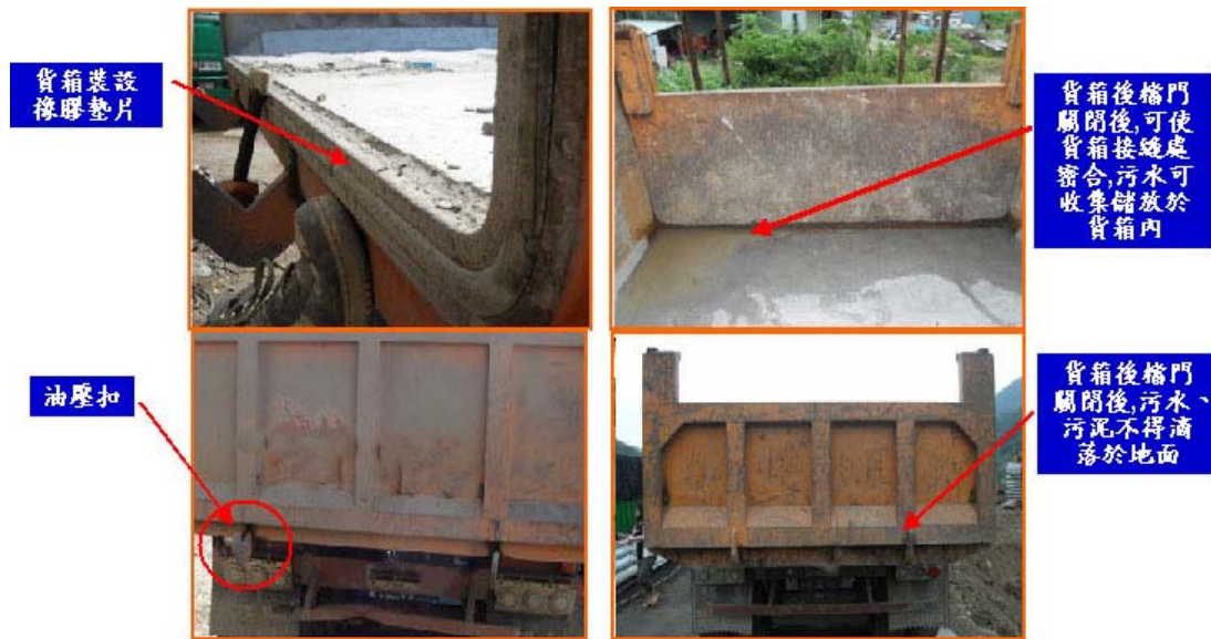
圖3-19 砂石車貨箱設置阻隔設施實照
