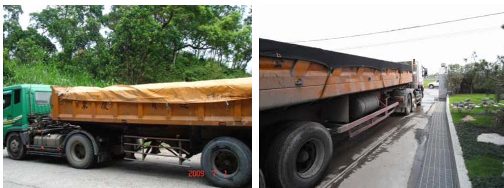
圖3-17 砂石車貨箱覆蓋防塵布(網)實照
